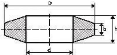
Пример условного обозначения: D x d x h x b, где:
